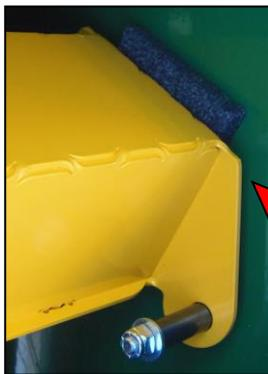
**Precaución:** Retire los cojines de espuma de entre los lados de la caja y el carro de la rebajadora antes de hacer funcionar la máquina (Figura 5).
